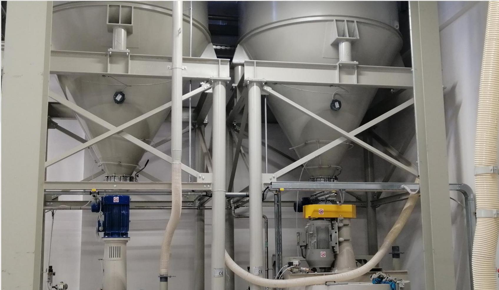
Tutte le polveri che si generano nel processo produttivo vengono aspirate e in seguito riutilizzate come materia prima
